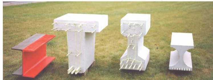
Сталь, Армированный бетон, Предварительно-напряженный бетон, Dustal, 117 кг, 530 кг, 140 кг, 467 кг
